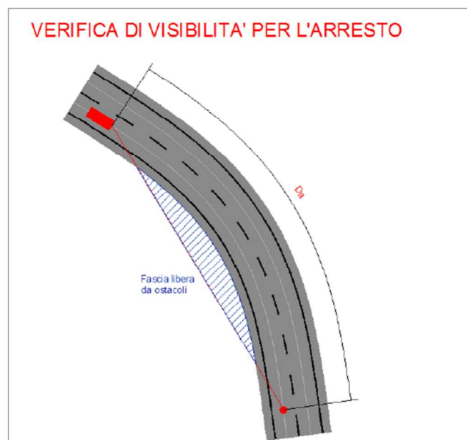
Figura 9: schema per l'esecuzione della verifica di visibilità per l'arresto
